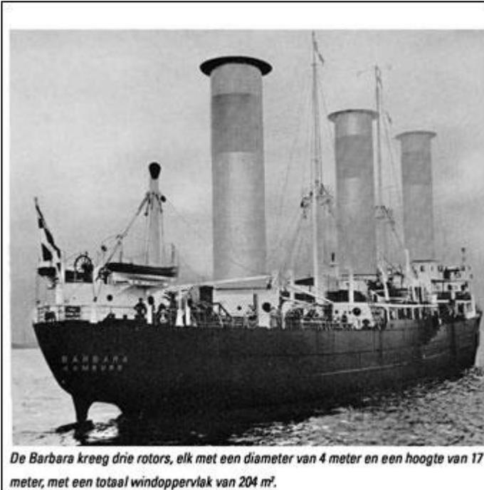
*De Barbara kreeg drie rotors, elk met een diameter van 4 meter en een hoogte van 17 meter, met een totaal windoppervlak van 204 m<sup>2</sup>.*
