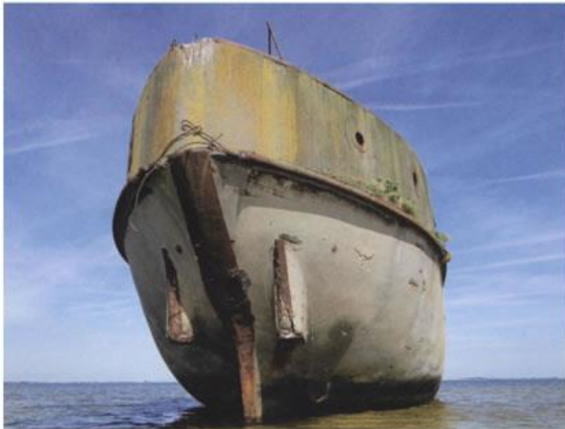
De Redentin gestrand in de Wismarbucht, Oostzee, gebouwd in 1943-1944 in Ostwine door Dyckerhoff & Widman, met een lengte van 40,5 m, schalenbouw volgens het type Seeleichter Wiking Motor . Een zusterschip, de Capella , werd gerestaureerd en is te bezichtigen in het scheepvaartmuseum in Rostock (© Heidmarie Kuck)
