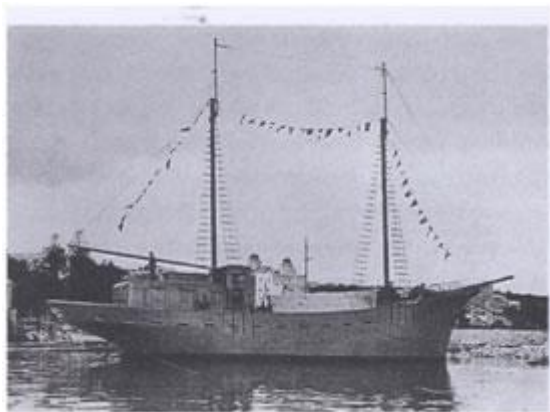
De Irene, motor zeiljacht van 165 ton, gebouwd in 1945 ten zuiden van Rome, op de scheepswerf van Lazzarini en Meacci, eerste toepassing van een brevet voor het ferrocemento van Pier Luigi Nervi
